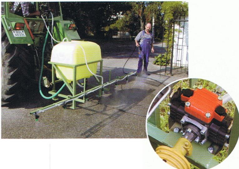
Membranpumpe mit Zapfwellenanschluss
